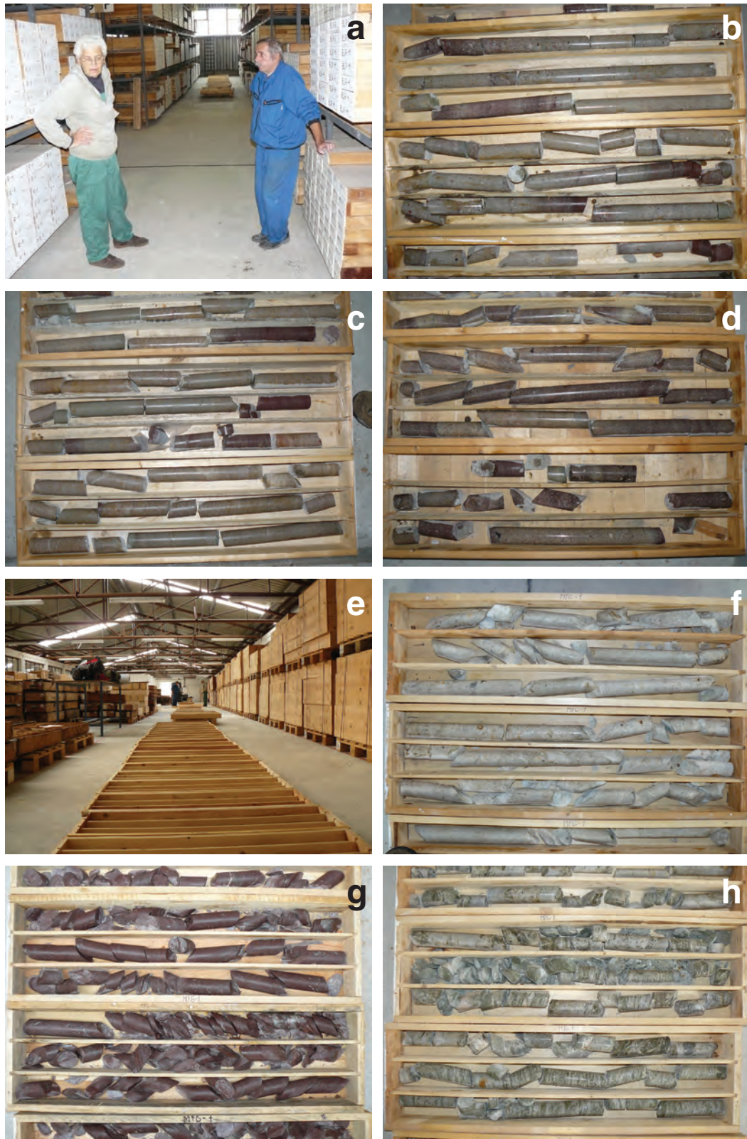
Obr. 29. a – Sklad hmotnej dokumentácie v Kráľovej pri Senci, v pozadí časť rozloženého vrtu KV-1; b – hrubozrnné kremenné arkózy až drobnozrnné zlepenice lúžňanského súvrstvia s polohami stredno- až hrubozrnných pestrých drôb vo vrchných častiach lavíc s badateľným paralelným a šikým zvrstvením v úseku 78 – 84 m; c – svetlé stredno- až hrubozrnné kremenné arkózy lúžňanského súvrstvia z úseku 172 – 176 m; d – pestré drobnozrnné zlepenice stráňanského súvrstvia s úlomkami tzv. hematitizovaných vulkanitov v úseku 420 – 426 m; e – pohľad na rozložený vrt MFG-1 v skladoch hmotnej dokumentácie v Bratislave-Trnávke; f – svetlé kremenné hrubozrnné arkózy až drobnozrnné zlepenice karpatského keuperu v úseku 95 – 101 m; g – pestré piesčité bridlice karpatského keuperu s početnými zelenými (choritickými) konkréciami v úseku 128 – 135 m; h – tektonicky postihnuté ílovité dolomity s evaporitmi v blízkosti kontaktu so stráňanským súvrstvom v úseku 184 – 191 m.
